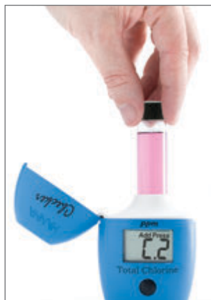
3. Coloque la celda en su Checker ® HC
