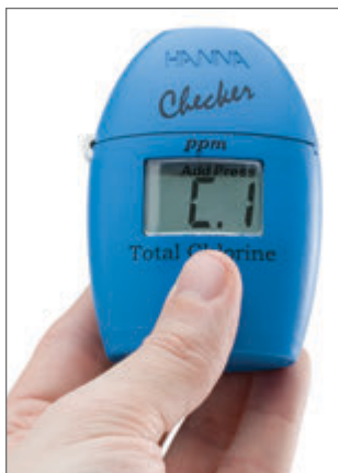
1. Realice el cero en el Checker ® HC con su muestra de agua sin reactivo
